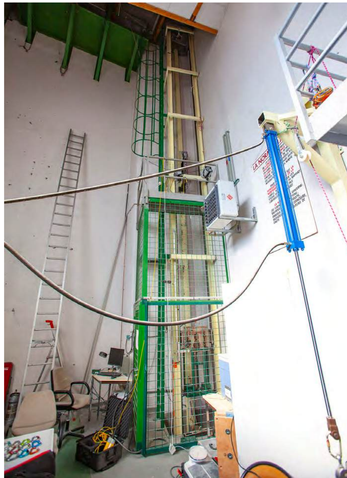
Figure 3: Tour de chute de l'ENSA ; un masse rigide guidée de 40 à 140 kg peut chuter de 12 mètres.
